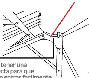
/El tanque debe tener una alineación correcta para que los tubos puedan entrar facilmente.
